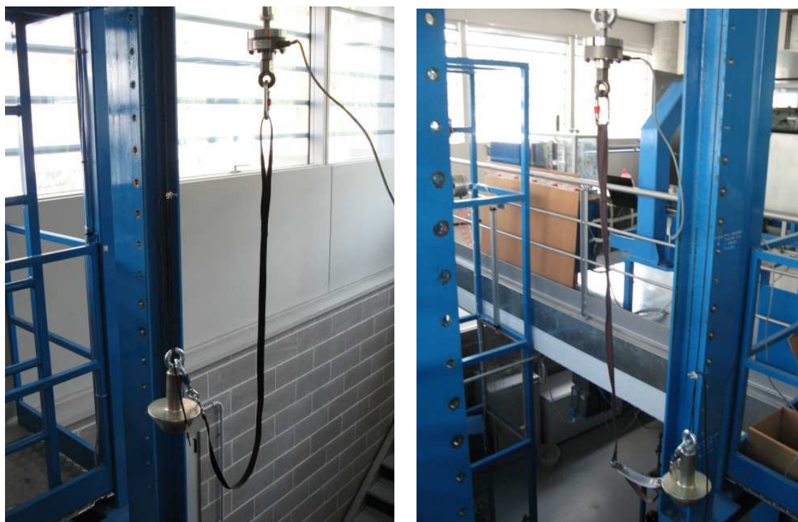
Figura 3: Prova dinamica: a sinistra con guinzaglio rigido e a destra con guinzaglio WAW
