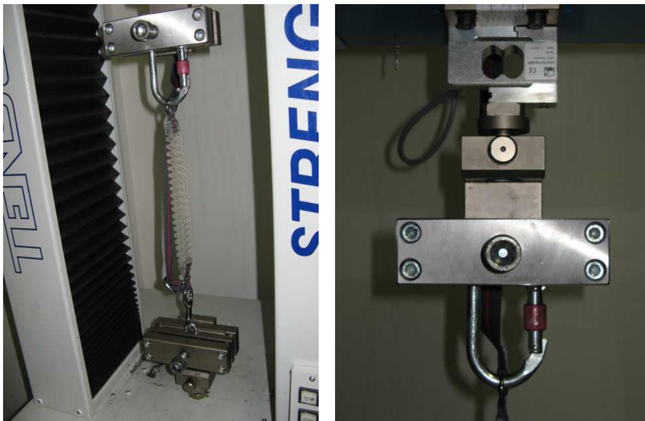
Figura 1: Prova statica su guinzagli; a destra immagine del bloccaggio a morsa e della cella di carico da 1 kN utilizzata per la registrazione della forza trasmessa
